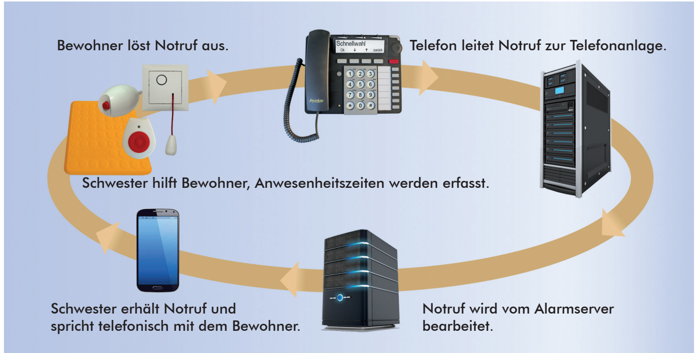
Abbildung: Ergophone Rufauslöser und Telefon in Verbindung mit Systemkomponenten anderer Hersteller.
